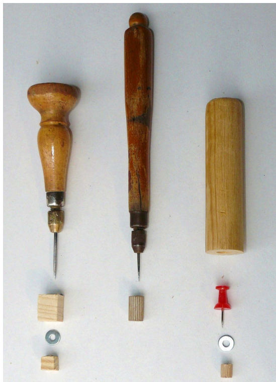
Verschiedene Lochstecher mit unterschiedlichen und zerlegten Tiefenbegrenzern.
