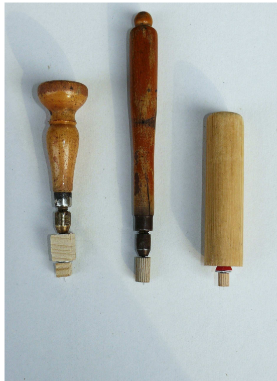
Lochstecher mit aufgesetzten Tiefenbegrenzern: Nur die dünnen Stahl-Spitzen ragen noch heraus.
